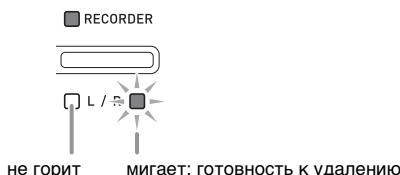
**4.** Еще раз нажать на кнопку «FUNCTION» и, не отпуская ее, нажать на кнопку «RECODER (L/R)».
