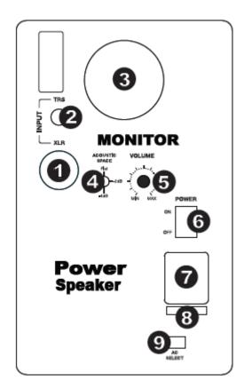
места в студии. Поэтому мониторы имеют переключатель акустического пространства. Данный переключатель позволяет компенсировать размещение вблизи стен.
