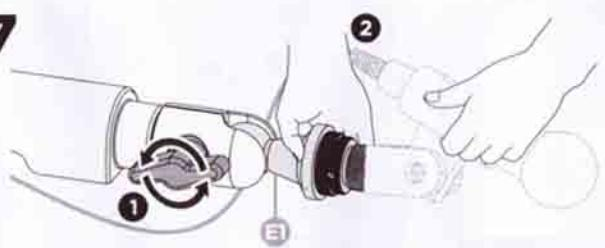
Удерживайте соединение (E1) и ослабьте ручку, установите микрофон в нужное положение, затем затяните ручку.
