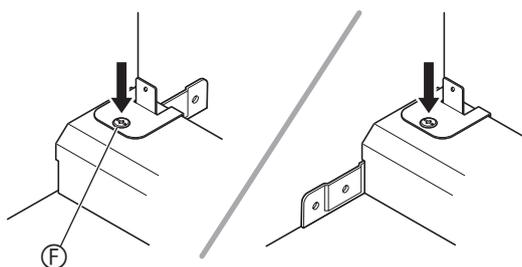
9. После корректировки высоты педального блока **E** затянуть винты, которыми при выполнении вышеописанного действия 5 были временно зафиксированы кронштейны и накладки.
