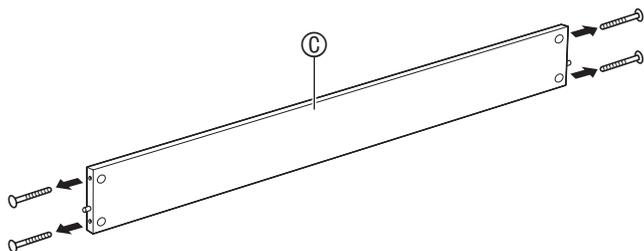
2. Боковые панели А и В прикрепить к тыльной панели ©. Боковые панели А и В привинтить к тыльной панели © винтами, извлеченными при выполнении действия 1.
