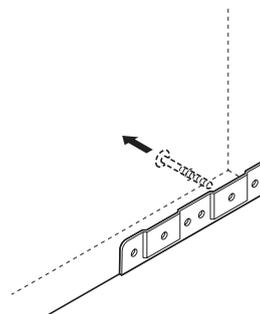
4. Угловые кронштейны **H** вставить в зазор между накладкой для повышения устойчивости и боковой панелью.
