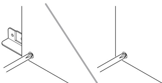
10. Тыльную панель **C** прикрепить к тыльной панели **K**.
