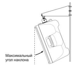
Угол наклона зависит от относительного положения между колонкой и стеной. Максимальный угол наклона вниз приведен в следующей таблице.
